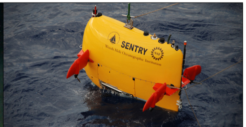
El vehículo autónomo submarino Sentry puede desplazarse a 6,000 metros de profundidad y lleva tanto un sonar multihaz como cámaras de alta definición. Imagen por cortesía de DEEP SEARCH 2017, NOAA-OER/BOEM/USGS.
