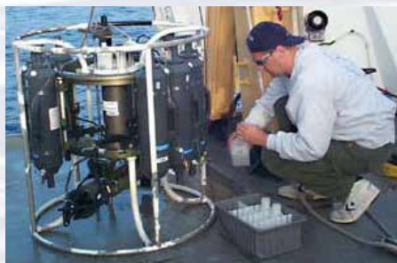
Un CTD se une a una estructura metálica llamada roseta, o carrusel, junto con numerosas botellas de muestreo de agua y cuando se despliega, proporciona información sobre la composición de la columna de agua. Imagen: NOAA.
